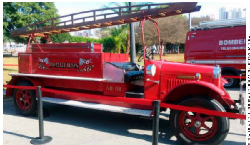
Bomba de incêndio Hatfield , originalmente de tração animal, adaptada a um chassi internacional
