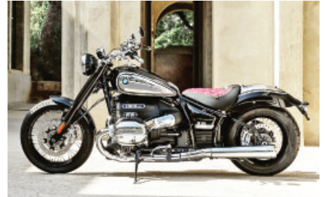
BMW R18 100 - Years Cruiser, modelo movido por um motor Boxer de 91cv
