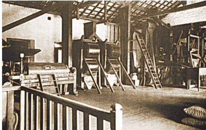
Interior de uma casa de máquinas, em que se pode ver um ventilador simples, um descascador Mac Hardy, dois ventiladores duplos, um catador e um aparelho Monitor
