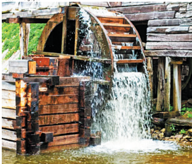
Roda d'água movimenta moinho e monjolo (engenho rústico movido por água destinado a pilar milho)
