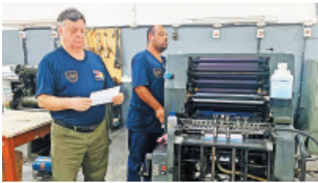
Marcon examina impressão executada por Edson Oliveira (ao fundo) na impressora off set
